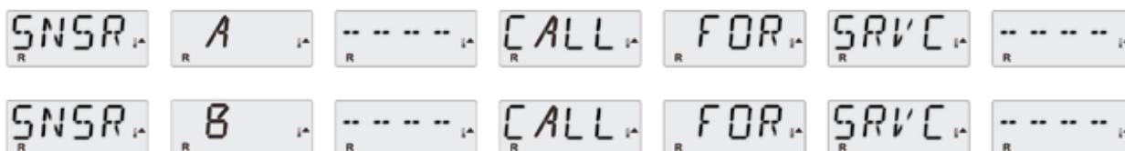
Un capteur de température ou un circuit de capteur est défectueux. **Contactez le support technique.**
